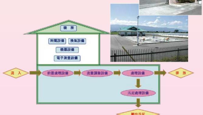
適合農村形態的污水處理系統：從村落與住家的分布狀況、水循環系統維持及自然淨化機能的有效活用觀點並以一~數村落單位來計算，小規模分散型污水處理方式較為合適。
