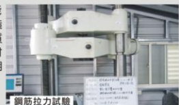
鋼筋拉力試驗
